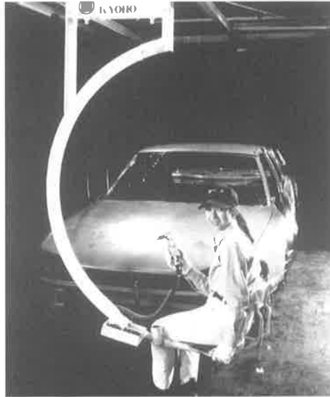
腰痛予防の姿勢点や腓骨神経麻痺予防の下肢点のcheckからaction(生産技術的対応)が生まれた —自動車組立ラインに開発されたらくらく作業シート—1992年
