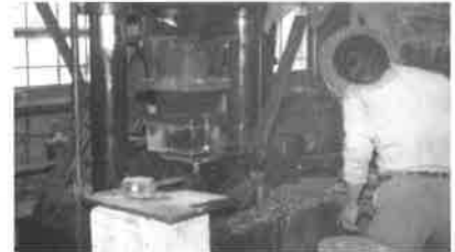
耐火レンガのプレス成型 (タイルも同様だが発じんは多い)
