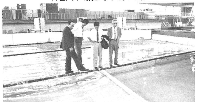
(5図) 人工波浪によるモデル実験
